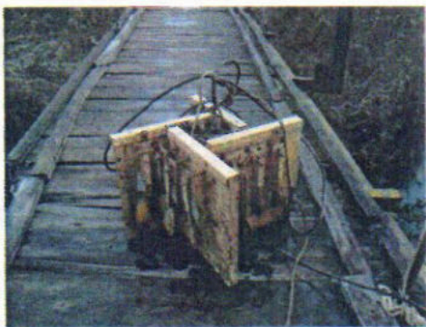
Рис. 1. Блок регистрации поведения моллюсков комплекса автоматизированного мониторинга водной среды на переходных мостках гидроузла № 14
