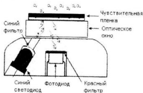
Р и с. 1. Конструкция головки измерителя, основанного на динамической люминесценции
