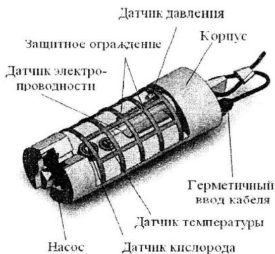
Р и с. 4. Компоновка прибора со средствами борьбы с обрастанием
