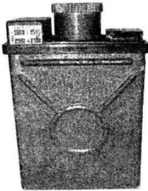
Р и с. 1. Цифровое устройство для измерения параметров пространственных колебаний подвижных объектов (ИПК)
