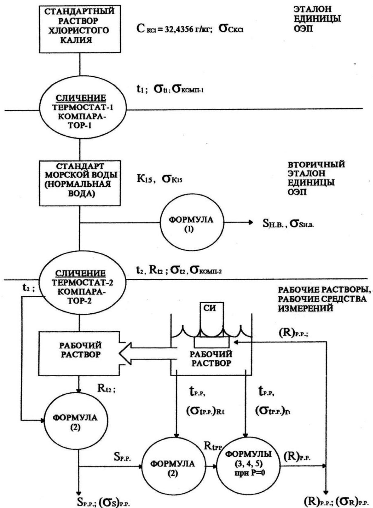
няемых с помощью формулы (2) для получения значений  $R_{t2}$  и практической солености  $S_{p,p}$  морской воды или рабочего раствора. Для определения ОЭП ( $R$ )<sub>p,p</sub> рабочего раствора градуируемого (или поверяемого) средства измерений (СИ) необходимо знать, а следовательно и измерить, температуру рабочего раствора  $t_{p,p}$ , чтобы с помощью формул (2), (3), (4), (5) или (6) значения  $R_{t2}$  привести к ( $R$ )<sub>p,p</sub>.
