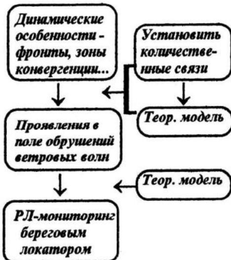
Рис.1 Схема контроля за процессами перемешивания в прибрежной зоне (слева). Ее реализация требует научных разработок, перечисленных справа.
