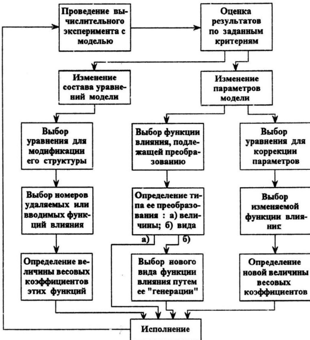
Рис. 3. Алгоритм реализации операций коррекции модели МПХК "море-суша".
