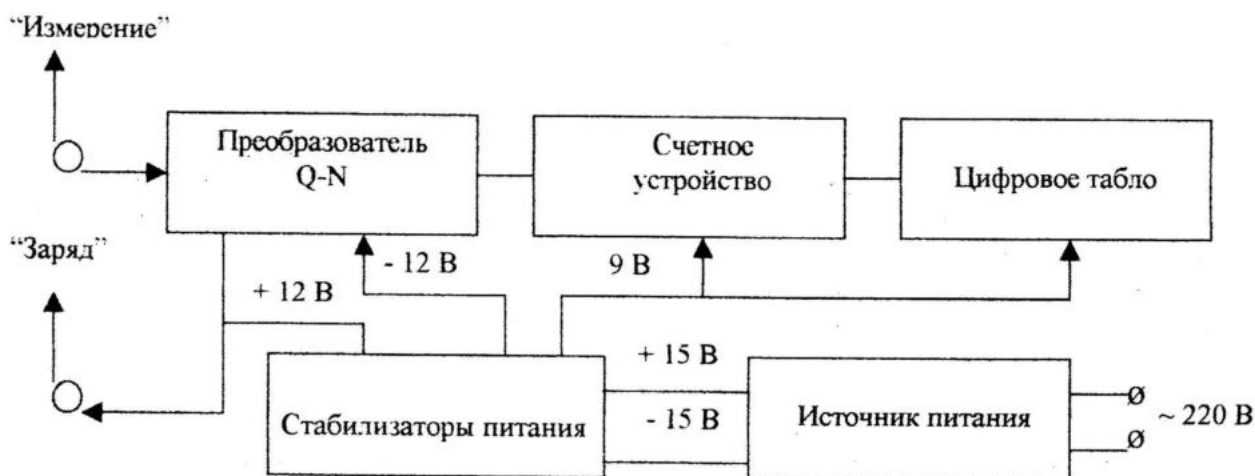
Рис. 2. Функциональная схема измерительного пульта
