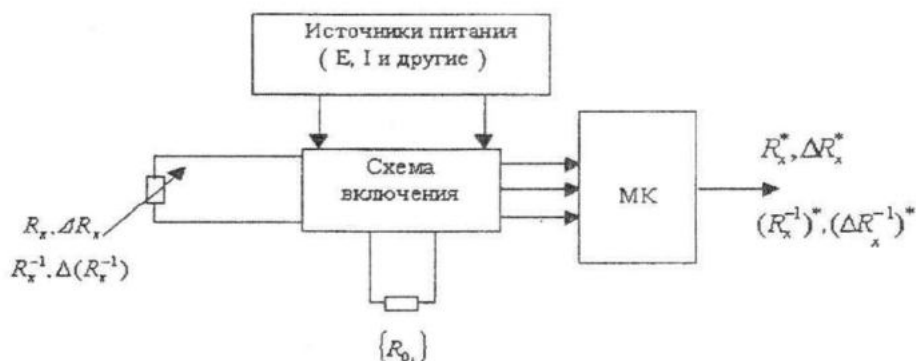
Рис. 1 – Обобщенная блок-схема параметрически инвариантного канала преобразования параметров резисторного датчика
