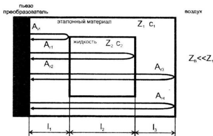
Рисунок 2 – Схема устройства преобразователя и пути прохождения акустических импульсов
