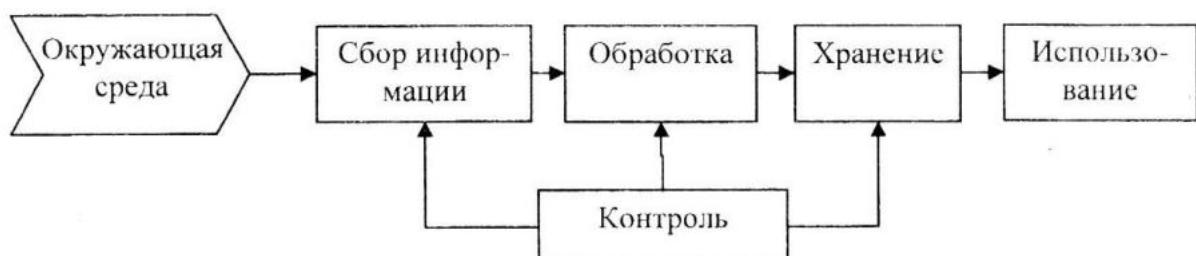
Рисунок 1 – Цикл движения гидрометеорологических данных
