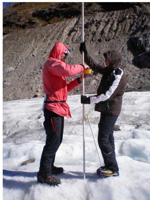
Р и с. 1. Установка абляционной рейки на леднике Перс (Pers), массив Бернина, Швейцария (фото О.О. Рыбака, 2014 г.)
