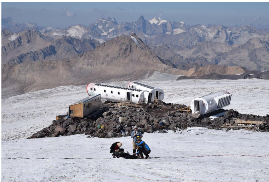
Р и с. 2. Измерение толщины льда точечным радаром и попутное определение координат с помощью спутниковой системы глобального позиционирования; ледник Гарабаши, Центральный Кавказ, Россия (фото Р. Нуубреchts, 2015 г.)
