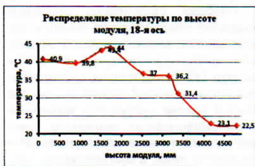
Рис. 4. Графики распределения температуры по высоте 1-го модуля I-го ряда
