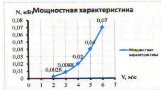
Рис. 6. Расчетная мощностная характеристика исследуемой ветроустановки при C_p = 0,3
