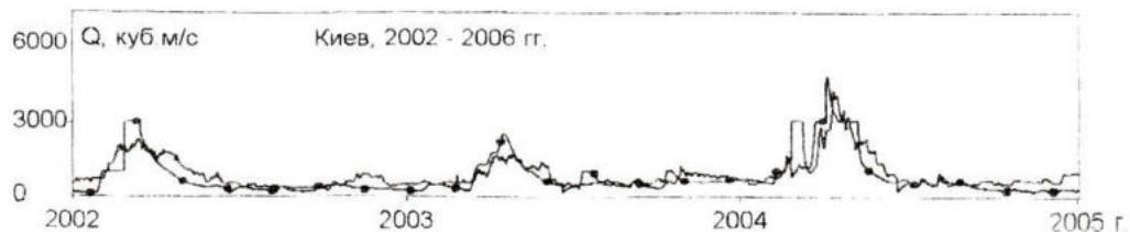
Р и с. 3. Модельные (—●—) и наблюденные (—) среднесуточные сработки ( $\text{м}^3/\text{сут}$ )
