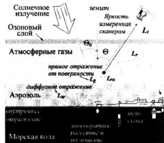
Р и с. 1. Схема биооптического подспутникового эксперимента
