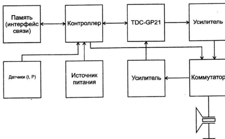
Рис. 1. Структурно-функциональная схема измерителя скорости звука
