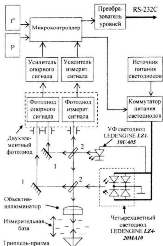
Р и с. 3. Функциональная схема спектрального измерителя прозрачности
