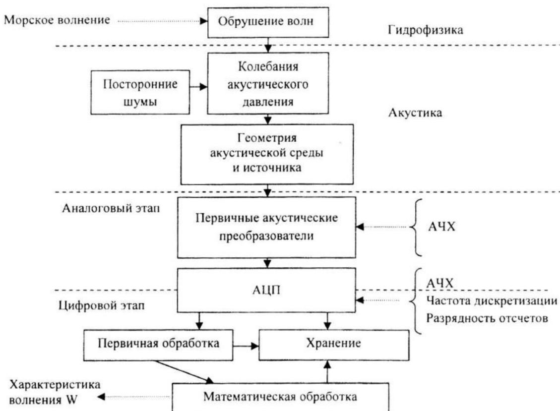
Рис. 1. Схема акустических наблюдений за морским прибрежным волнением
