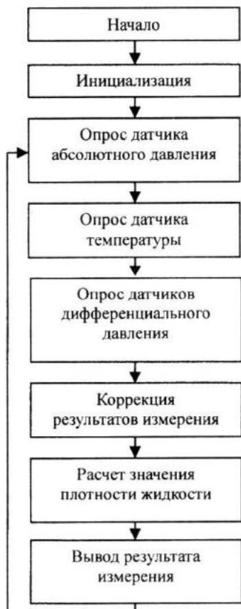
Рис. 3. Алгоритм работы гидростатического измерителя плотности
