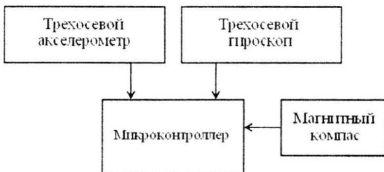
Р и с. 1. Структурная схема инерциальной навигационной системы
