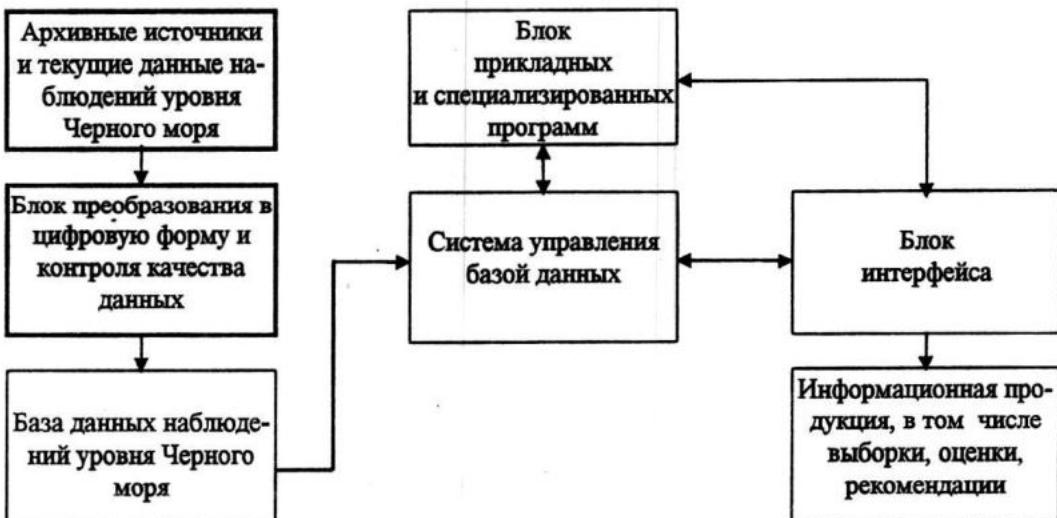
Рисунок 1. Структурная схема информационной системы уровня Черного моря
