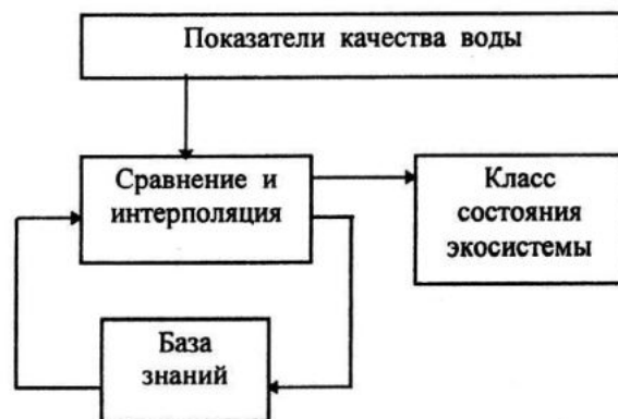
Рис. 4. Схема этапов блока классификации
