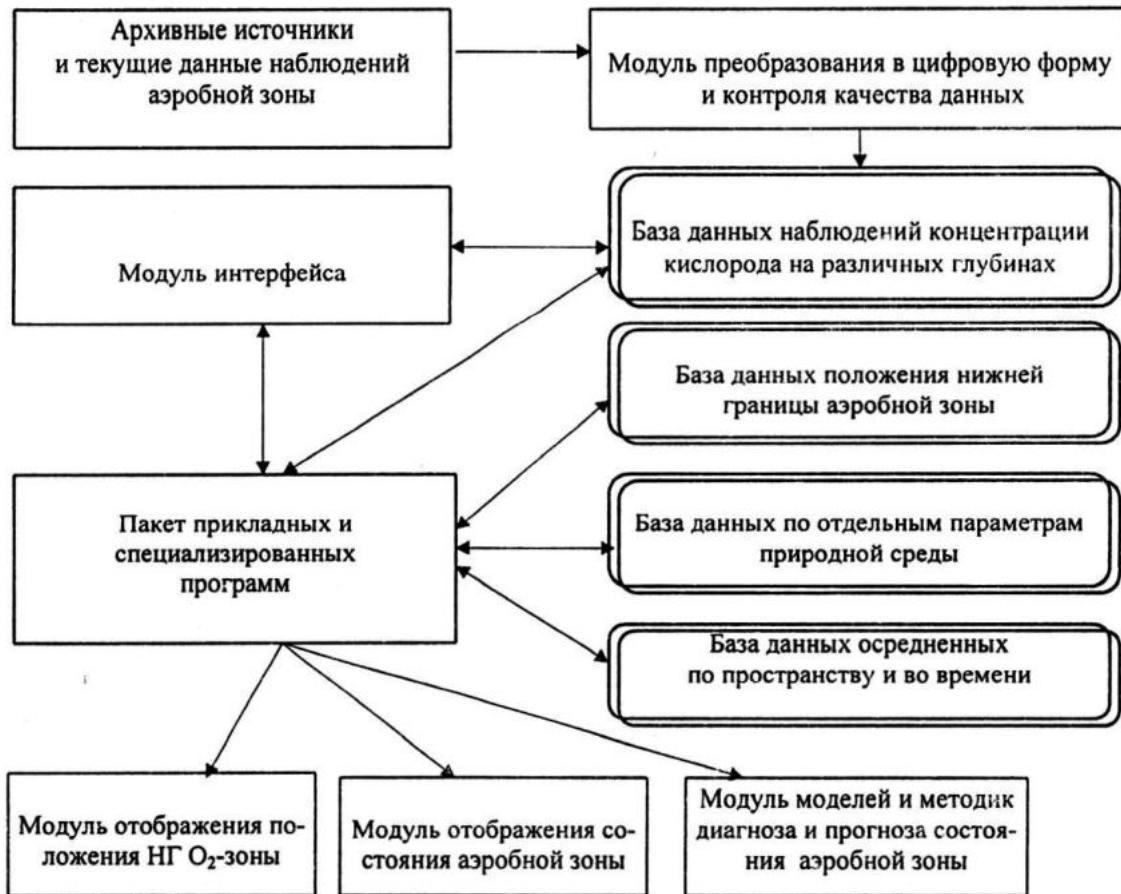
Рисунок 1- Структурная схема информационной системы исследования и отображения аэробной зоны Черного моря.
