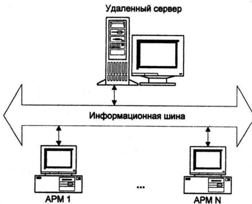
Рисунок 2 - Структура информационных связей в наблюдательной системе за состоянием АРБ, находящихся в эксплуатации
