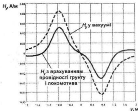
Рис. 14–Напруженість магнітного поля над рейковою парою з урахуванням впливу ґрунту і локомотива
