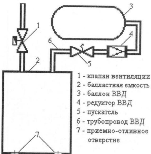
Рис. 1 – Принципиальная схема системы погружения-всплытия МВУ
