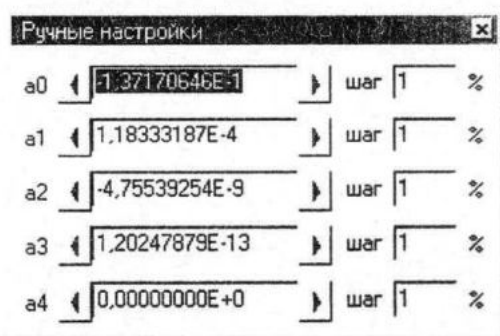
Рис. 7 - Окно ручного ввода и подстройки градуировочных коэффициентов выбранного метода регрессии
