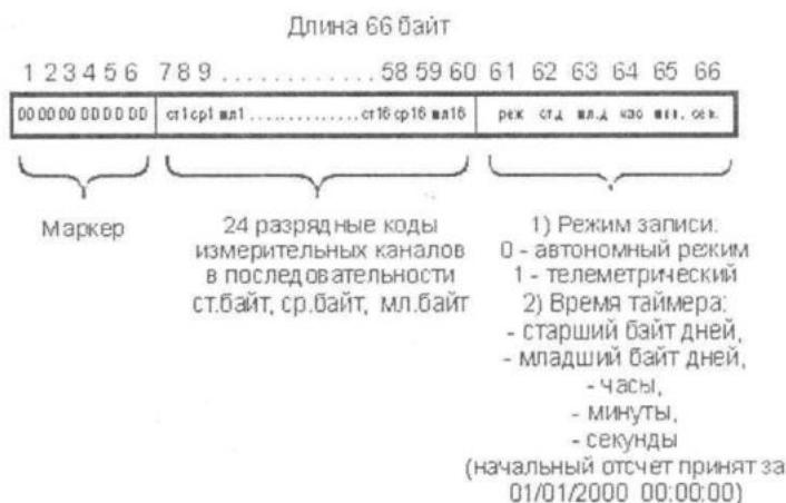
Рис.4 - Формат основного измерительного кадра
