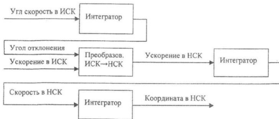
Рис. 3 – Структурная схема алгоритма обработки первичной навигационной информации
