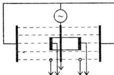
Рисунок 10 – Схема варианта электролитической ячейки с двумя вкладышами разных размеров
