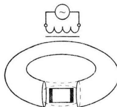
Рисунок 11 – Вариант электролитической ячейки с индуктивным формирователем электрического поля
