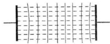
Рисунок 1 – Однородное электрическое поле в однородной жидкости между двумя плоско-параллельными пластинами
