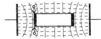
Рисунок 3 – Искажения однородного электрического поля диэлектрическим вкладышем с проводящими электродами на торцах
