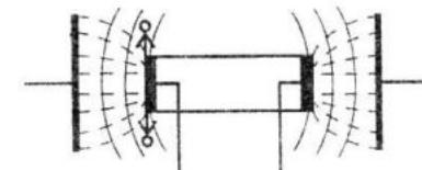
Рисунок 4 – Искажение однородного электрического поля диэлектрическим вкладышем с закороченными торцевыми электродами
