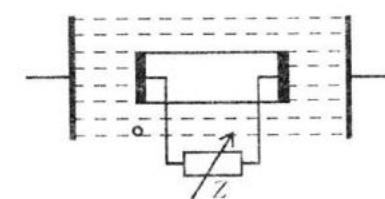
Рисунок 5 – Однородное электрическое поле с диэлектрическим вкладышем, между торцевыми электродами которого включено полное сопротивление, эквивалентное полному сопротивлению вытесненного вкладышем объема жидкости
