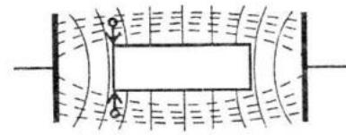
Рисунок 2 – Искажение однородного электрического поля диэлектрическим вкладышем
