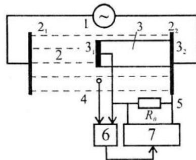
Рисунок 8 – Структурная схема измерителя с компенсацией напряжения на электродах вкладыша током на резисторе  $R_0$ , где 7 – источник тока уравновешивания, остальные обозначения аналогичны схеме на рисунке 6
