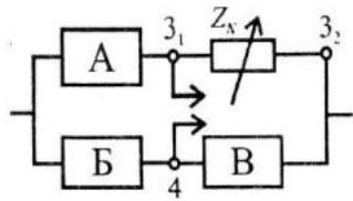
Рисунок 7 – Схема эквивалентного измерительного моста
