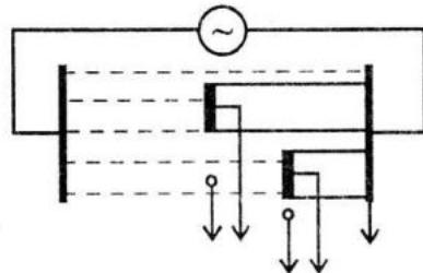
Рисунок 9 – Схема электролитической ячейки с двумя вкладышами разных размеров
