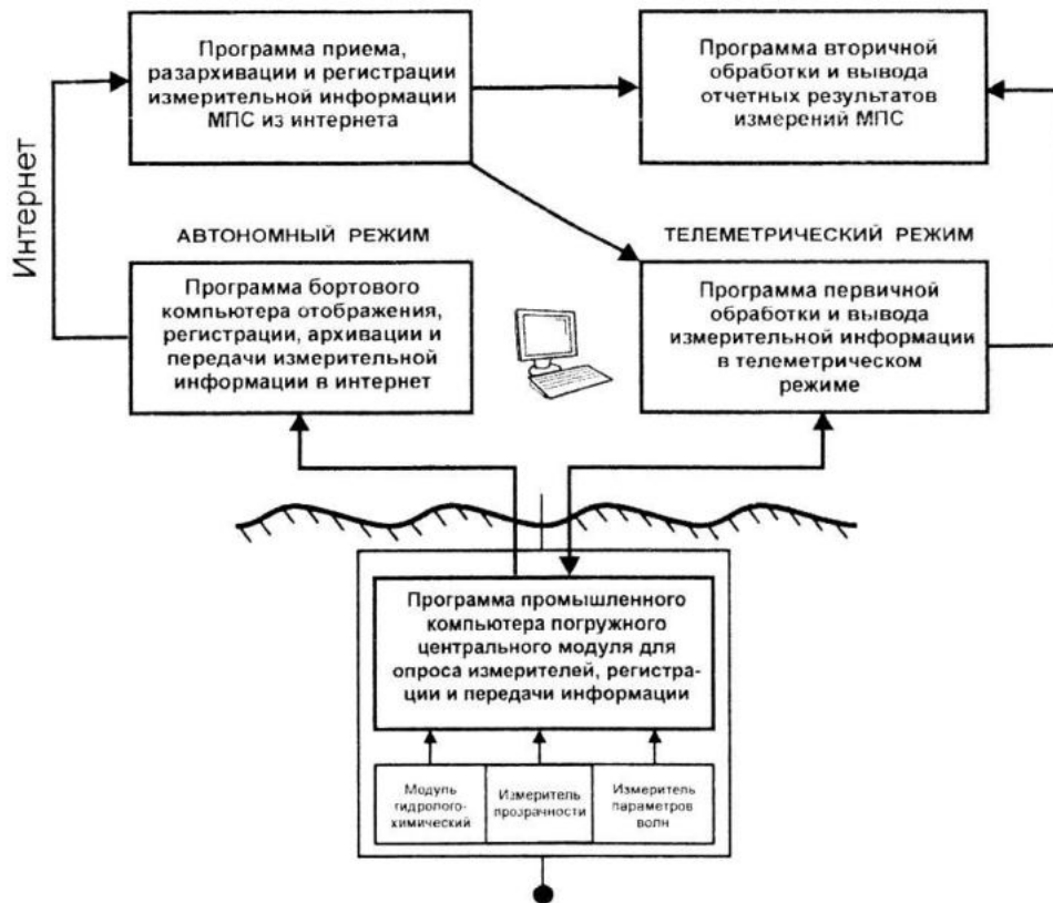
Рисунок 3 – Структурная схема организации работы программного обеспечения для приема и обработки данных с МПС "Бриз-1" на океанографической платформе
