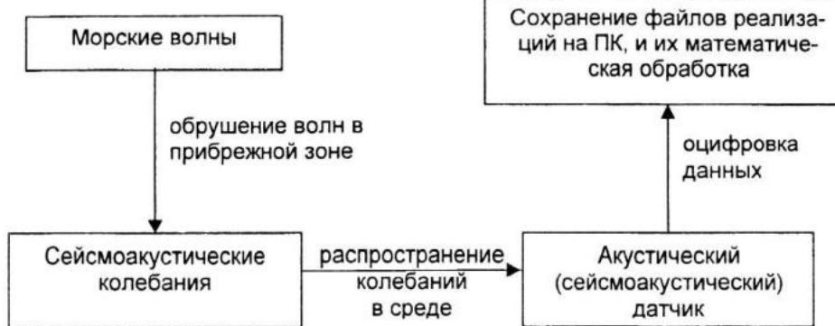
Рисунок 5 – Система сейсмоакустического наблюдения прибрежного волнения
