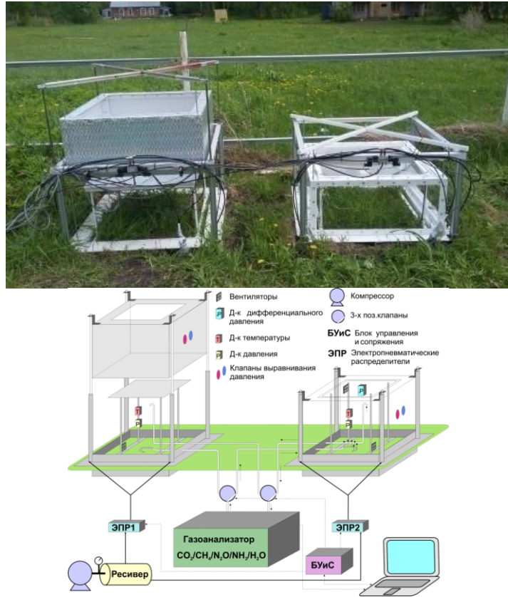
Рис. 4. Внешний вид и структурная схема камер для измерения потоков парниковых газов Fig. 4. Appearance and block diagram of chambers for measuring greenhouse gas flows
