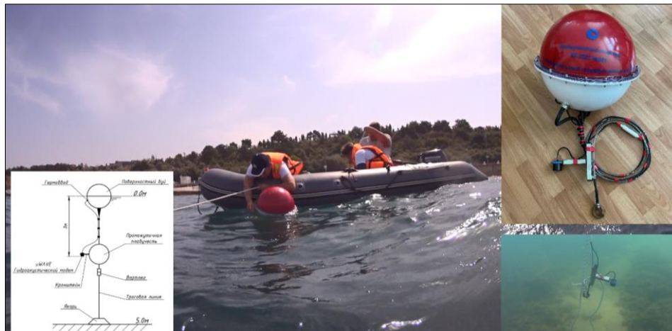
Рис. 5. Внешний вид морского коммуникационного буя с гидроакустическим модемом
