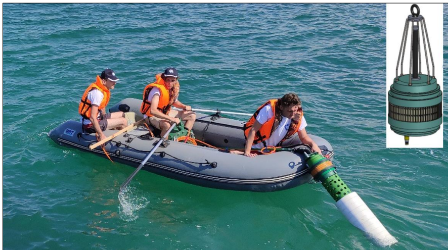
Рис. 3. Постановка ГАС «Манжетка» с дежурной шлюпки Fig. 3. Setting the "Cuff" from the rescue boat
