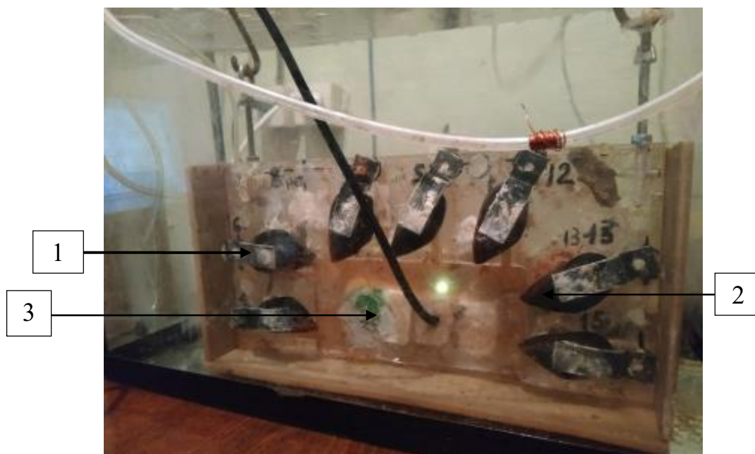
Рис. 2. Общий вид экспериментальной установки: 1 – пластина с магнитом, 2 – мидия, 3 – блок электроники
