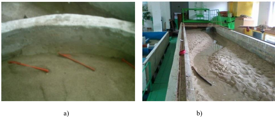
Рис. 6. Размывы в песчаном грунте у оголовков полузапруд, расположенных навстречу потоку под углами: а) 35°, б) 30°; размывов практически нет; движение потока: а) справа налево; б) от наблюдателя в конец лотка Fig. 6. Washouts in sandy soil at the heads of semi-dams located towards the flow at angles: а) 35°, б) 30°; there are practically no washouts; flow movement: а) from right to left; б) – from the observer to the end of the tray
