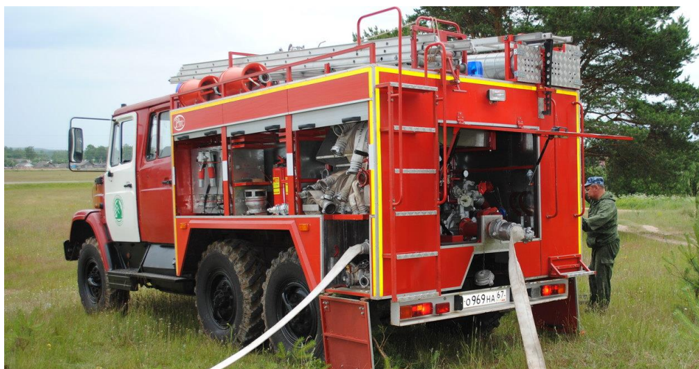
Рис. 3. Пожарно-химическая станция второго типа ПХС-2 Fig. 3. Fire-chemical station of the second type PHS-2
