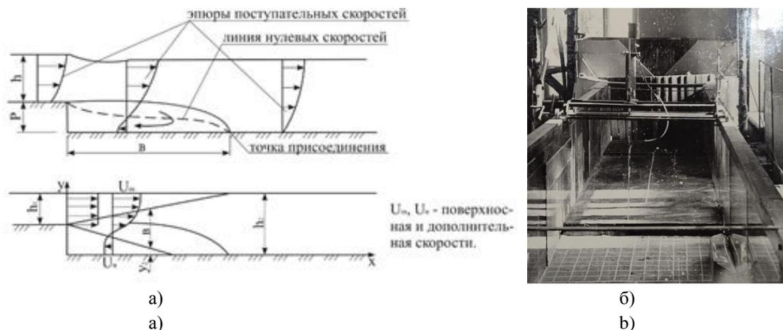
**Рис. 1.** Схема квази-плоского движения потока за донным уступом, расположенным перпендикулярно оси набегающего потока (а); фотография зеркального гидравлического лотка, в котором было проведено систематическое исследование течений за нормально и косорасположенными донными уступами (б)
