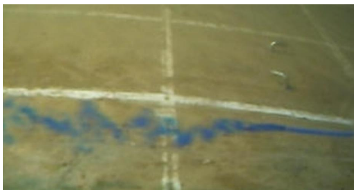
Рис. 3. Распространение красителя в потоке, набегающим на косорасположенную донную пластину Fig. 3. Spread of dye in a flow running onto an oblique bottom plate
